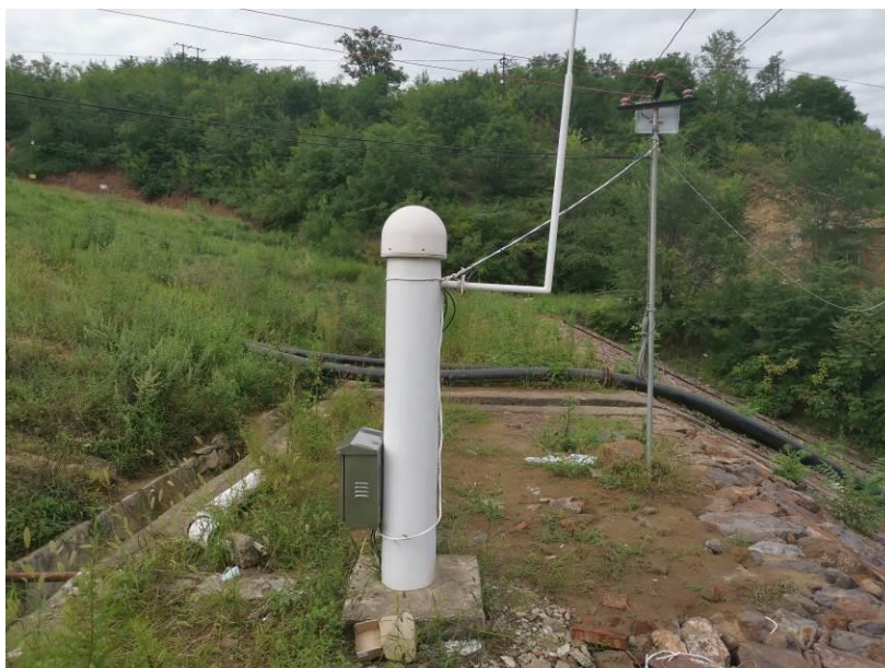
照片 21 初期坝顶表面位移
